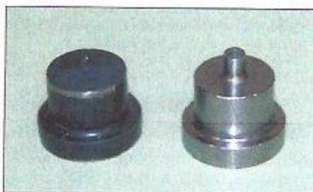
Figura 9 - Punções após o tratamento térmico. Fonte: Arquivo pessoal
